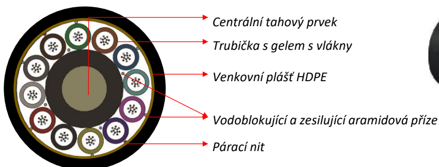
Příklad struktury závěsného kabelu (144 vl. 12x12)
